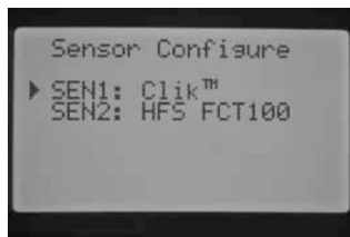
SEN 1 – метеодатчик SEN2 – датчик потока (HFS FCT100)
