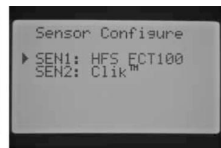
SEN 1 – датчик потока (HFS FCT100) SEN2 – метеодатчик
